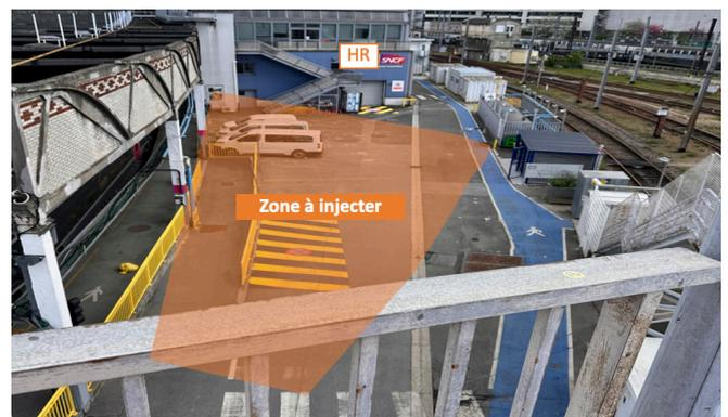
Ces comblements de carrière seront réalisés par injection de coulis, afin de remplir le vide dans le sol.
